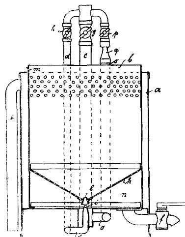
des zu waschenden Stoffes dienenden trichterförmigen Siebboden k versehen ist, gekennzeichnet durch ein unter der Mitte dieses Siebbodens derart angeordnetes Luftzuführungsrohr o, daß die eingeführte Luft, an der gelochten schrägen Fläche des Siebbodens entlang gleitend, gleichmäßig verteilt durch den Siebboden dringt und die darauf befindlichen Stoffe mitreißt. —
