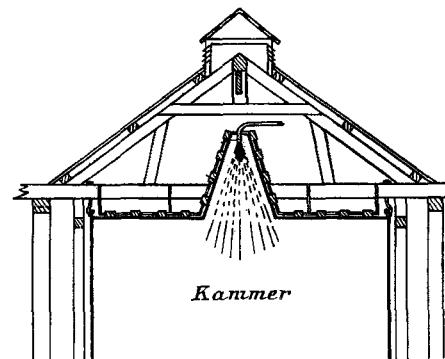
2. Bleikammer nach Anspruch 1, dadurch gekennzeichnet, daß die Aufsätze in konischer, dem Zerstäubungskegel angepaßter Form ausgebildet sind. —
