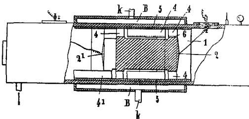
4 und 4<sup>1</sup> sind Porzellanklötzchen, in deren Nuten die Metallplatten mit ihren federartig ausgebildeten Enden 6 fassen. Die Platten 2<sup>1</sup> sind verschiebar, zu welchem Zweck die Nuten der Klötzchen 4<sup>1</sup> entsprechend lang sind. *Kn.*
