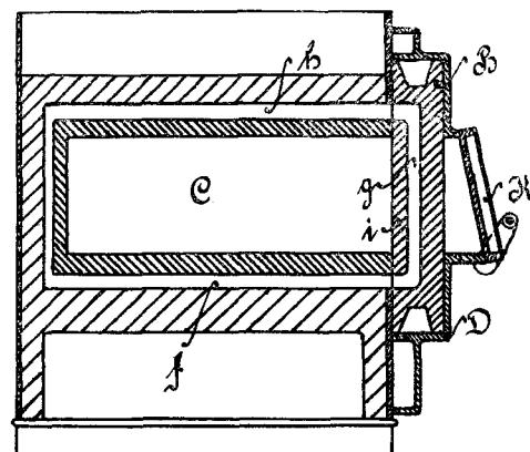
2. Ausführungsform des Schiebers nach Anspruch 1, dadurch gekennzeichnet, daß der Schieber B zum Schutz vor Abkühlung oder Beschädigung in einem doppelwandigen Gehäuse D geführt wird. —
